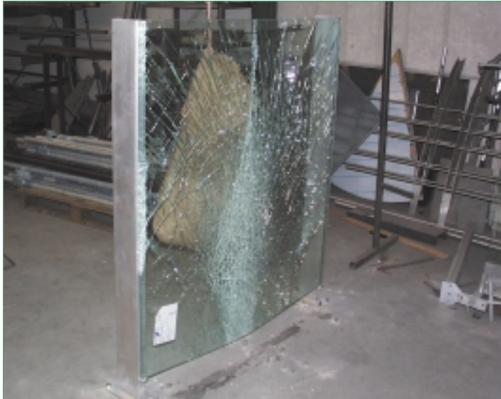
Om te voldoen aan STS 54 werd een dynamische test georganiseerd: een zandzak van 50 kg werd vanaf 3 m gekatapulteerd op de glasplaat.
